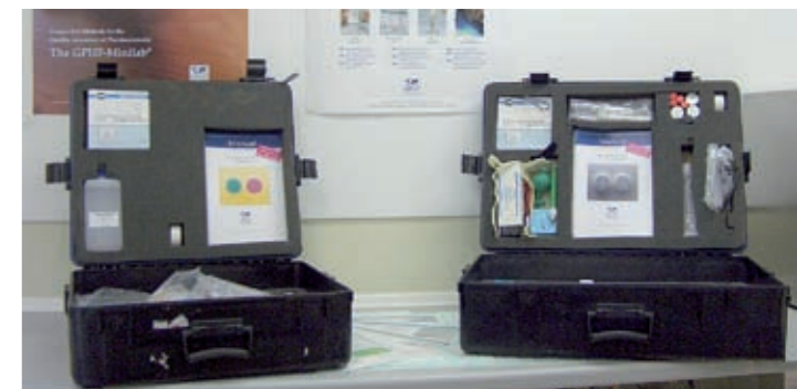
In zwei Koffer passt das „Minilab“, mit dem die Qualität von Medikamenten getestet werden kann. Foto: Difäm
